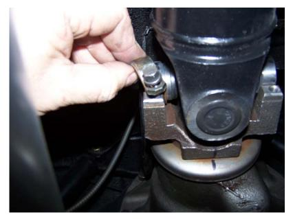
• PULL SLIP YOKE OUT TO MEET THE FRONT U-JOINT AND ATTACH.
