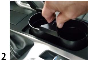
**PHOTO 2 – ONCE INSTALLED, THE CUP HOLDERS CAN BE PULLED INTO THE UP POSITION FOR USE. IN THE UP POSITION THE CUP HOLDERS SURROUND WATER BOTTLES, COFFEE CUPS, ETC. TO KEEP THEM FROM FALLING OVER DUE TO THE LOW DESIGN OF THE FACTORY CUP HOLDER.**
